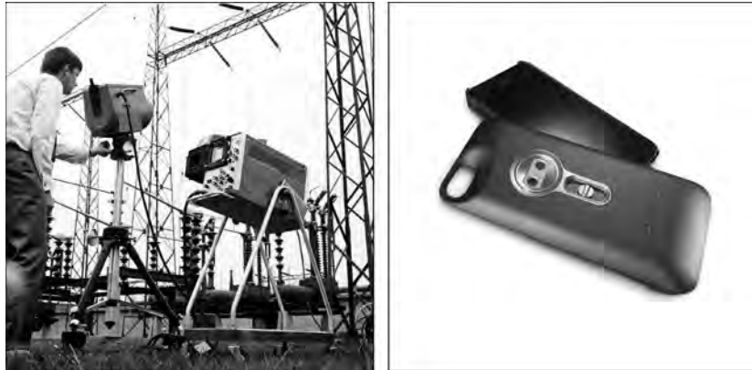
Kuva 13.2 VASEMMALLA: Thermovision-malli 661 vuodelta 1969. Kamera painoi noin 25 kg, oskilloskooppi 20 kg ja jalusta 15 kg. Käyttäjä tarvitsi myös 220 V:n vaihtovirtageneraattorin ja 10 litran säiliön nestemäistä tyyppiä. Oskilloskoopin vasemmalla puolella näkyy Polaroid-lisäosa (6 kg). OIKEALLA: FLIR One vuodelta 2014. Paikoilleen liu'utettava lisälaite, joka mahdollistaa iPhone'n lämpökuvausominaisuudet. Paino: 0,90 g.
